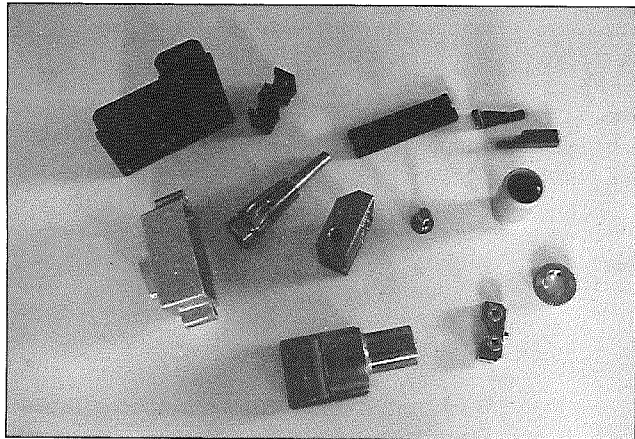
Her ses et lille udvalg af maskinbearbejdede emner, som maskinfabrikken kan dreje i en diameter fra 2 til 600 millimeter og fræse op til 1100x600x600 millimeter.
