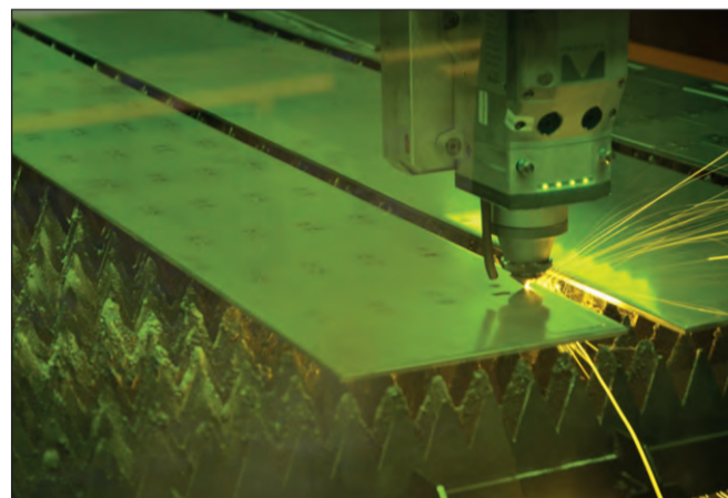
Fiberlaseren er udstyret med en tysk 4 fire kilowatts IPG-skærekilde.
